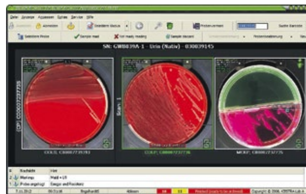
Abb. 2: Urinkulturplatten im ReadA-Browser von Kiestra. Agarplatten werden automatisch nach festgelegten Inkubationszeiten fotografiert und archiviert.
