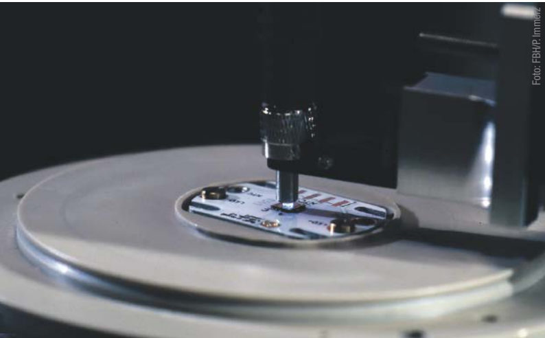
Laboraufbau mit Fern-UVC-LED-Chip bestehend aus Zehntausenden 235 nm Mikro-LEDs, die in eine Glasfaser emittieren
