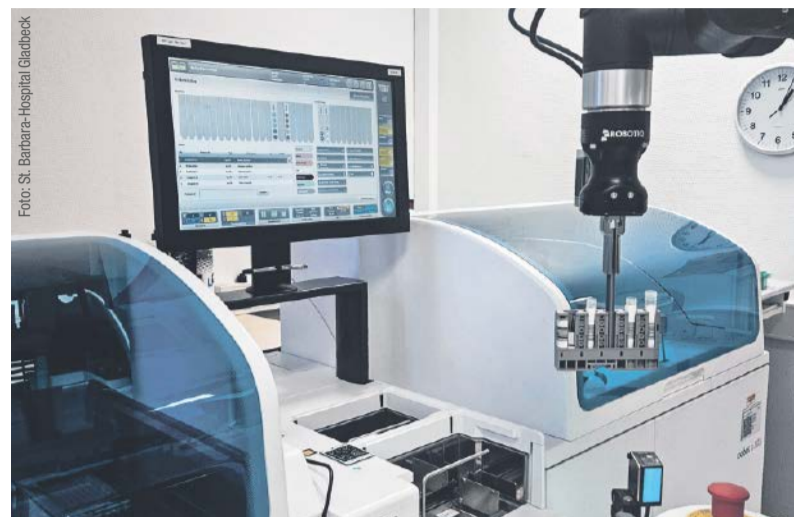
„uLab Mobile“ übermittelt Prozessdaten fortlaufend an das Laborinformationssystem zur vollständigen Rückverfolgbarkeit.
