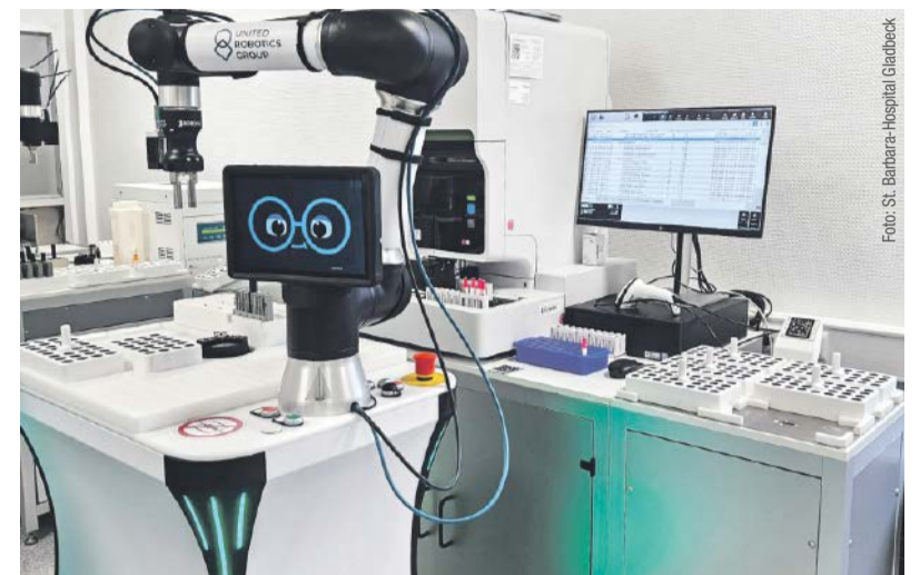
Im Durchschnitt bearbeitet „uLab Mobile“ nachts 150 Proben, mit hoher Reproduzierbarkeit und ohne Personalbindung.
