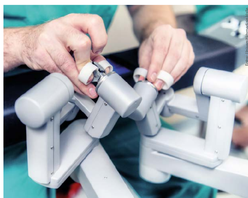
Der Roboter übersetzt die Handbewegungen des Chirurgen präzise und zitterfrei.
