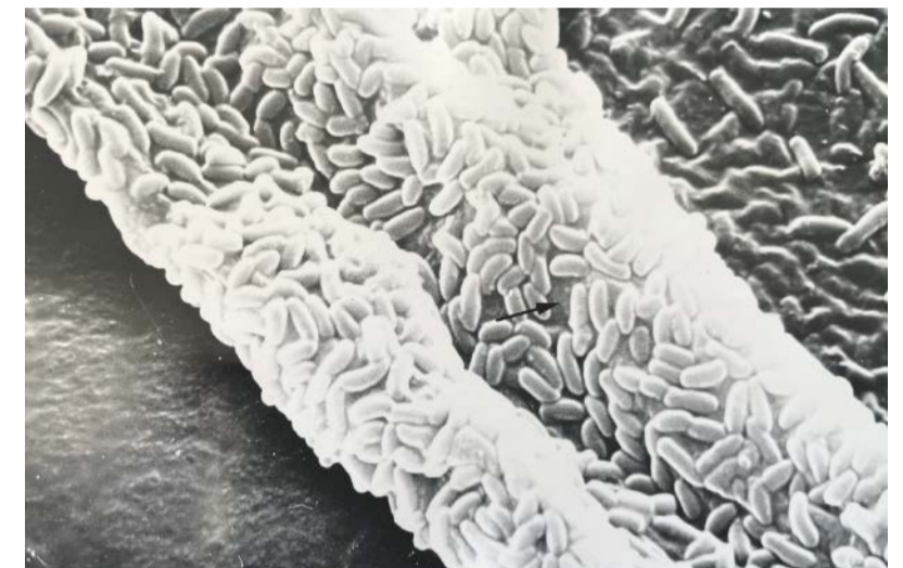
Die Induktion einer Biofilmbildung auf wasserdurchströmten Silikon-schlauchsystemen, die schließlich nach sieben Tagen zur Bildung eines flächendeckenden Biofilmes führte.
