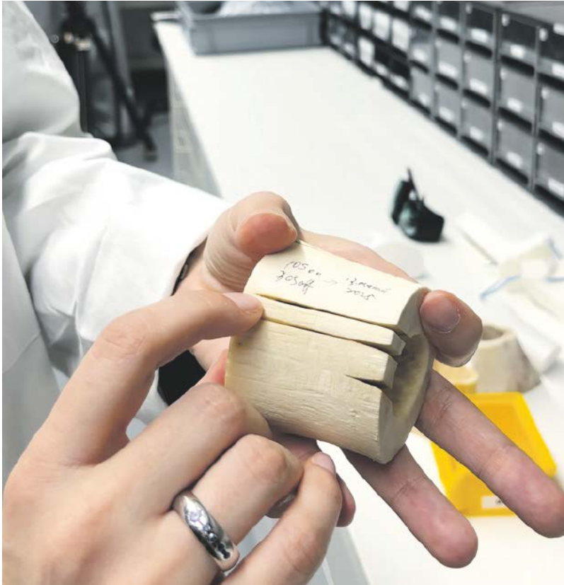
Chirurgische Laser konnten Knochen bisher nur sehr oberflächlich schneiden. Mit einer anderen Energieverteilung im Laserstrahl erreichen Forscher deutlich tiefere Schnitte als zuvor, hier am Beispiel von Rinderknochen.
