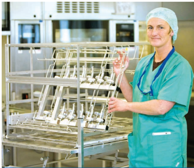
Effektive Unterstützung für die Sterilgutversorgung der Universitätsklinik Köln: Hier wurde der neue, modulare Kassetteneinsatz erfolgreich getestet, der die Aufbereitung größerer Mengen von Dental-Instrumenten in Reinigungs- und Desinfektionsautomaten unterschiedlicher Größen ermöglicht.
