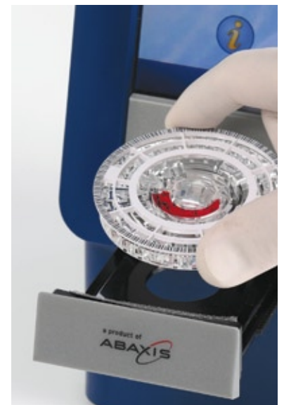
Reagensdisk mit 13 Parametern aus 100 µl Vollblut
