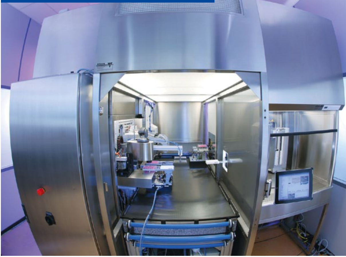
Abb. 1: Der CellCultivator steuert Zellkultivierungsprozesse vollkommen selbstständig. Teil des Systems ist ein am Fraunhofer IPM entwickeltes Mikroskop. Es erfasst und dokumentiert den Zustand der Zellen zu jedem Zeitpunkt des Wachstumsprozesses. (Bildquelle: Detlef Göckeritz)
