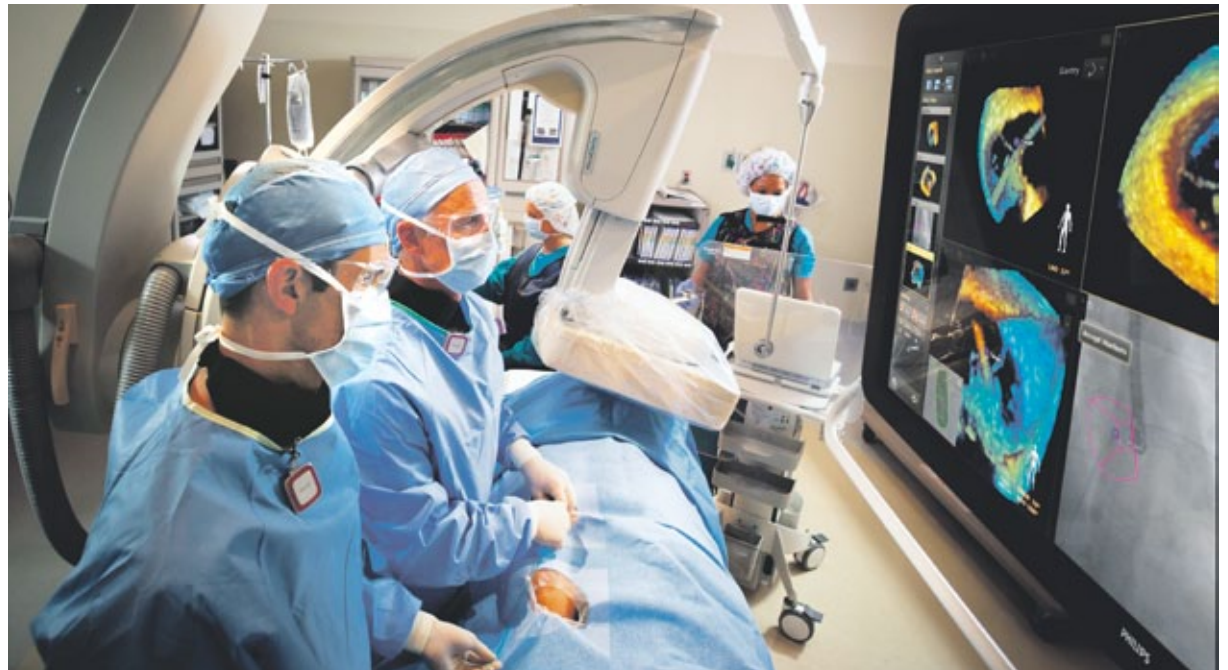
Der EchoNavigator im Operationssaal – Daten von Ultraschallbildern und Röntgenaufnahmen lassen sich erstmals in Echtzeit miteinander fusionieren.
