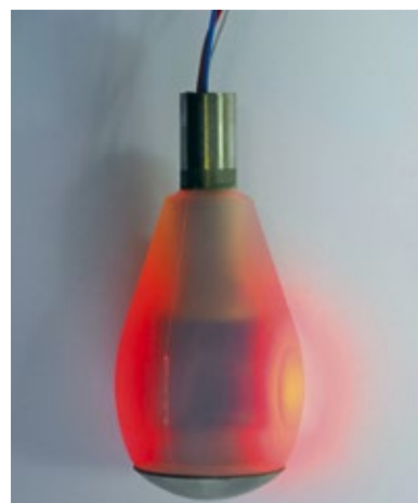
Ist der optimale Drehmoment erreicht, leuchtet eine LED im Innern des Instrumentengriffs auf. © Fraunhofer IPA
