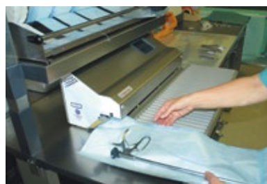
Heiß-Siegelgerät für eine validierungsfähige Verpackung von Medizinprodukten
