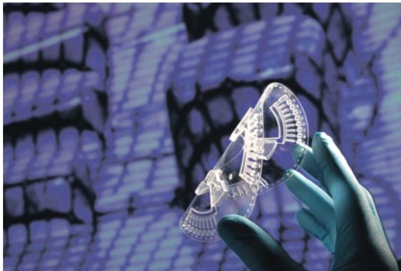
Die Foliendisk (links) wird zur vollautomatisierten Blutanalyse in ein Point-of-Care-Gerät eingelegt (rechts). / Quelle: IMTEK/Bernd Müller
