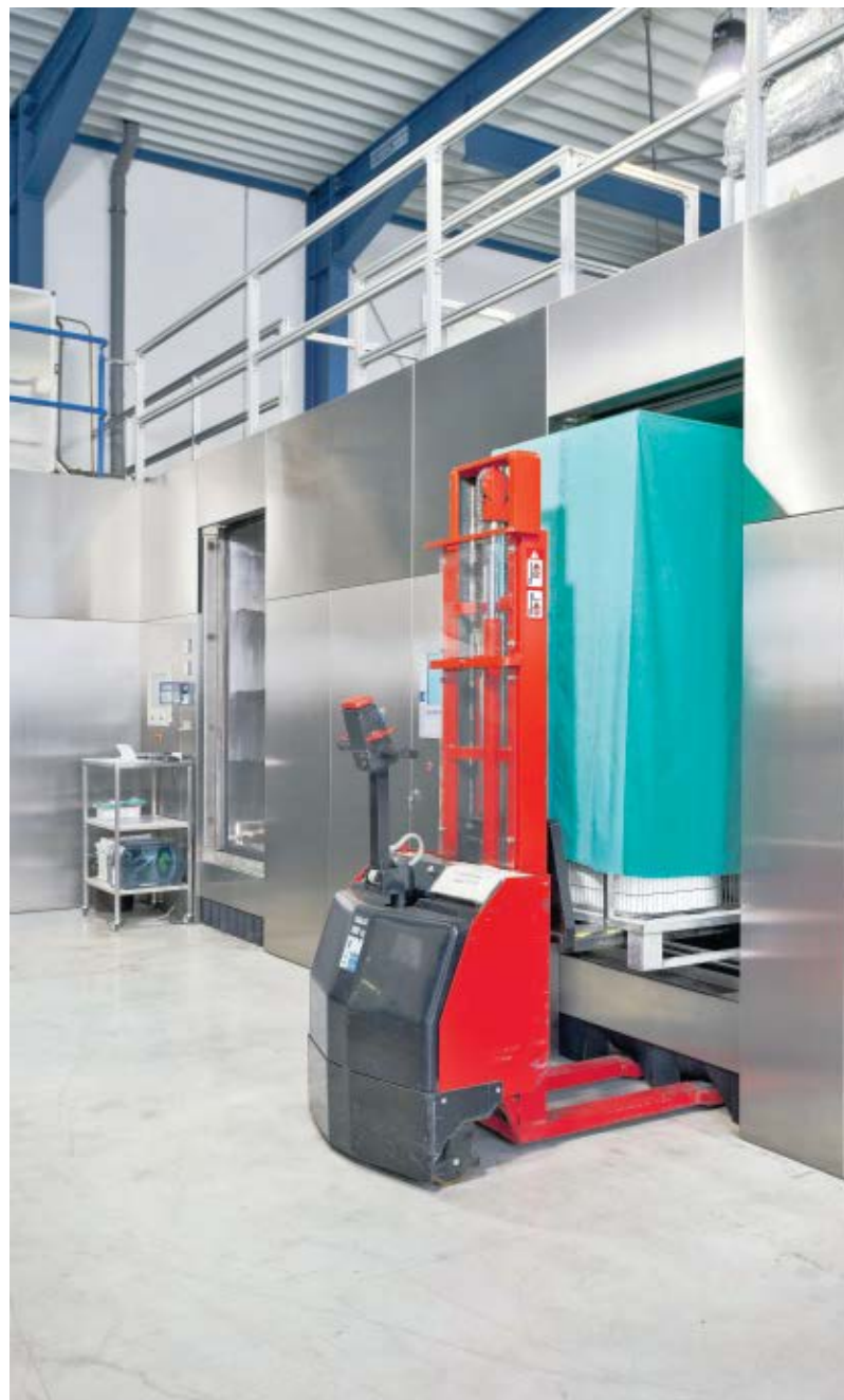
Beladung von Medizinprodukten in einen modernen vollautomatischen Ethylenoxid-Sterilisator.
