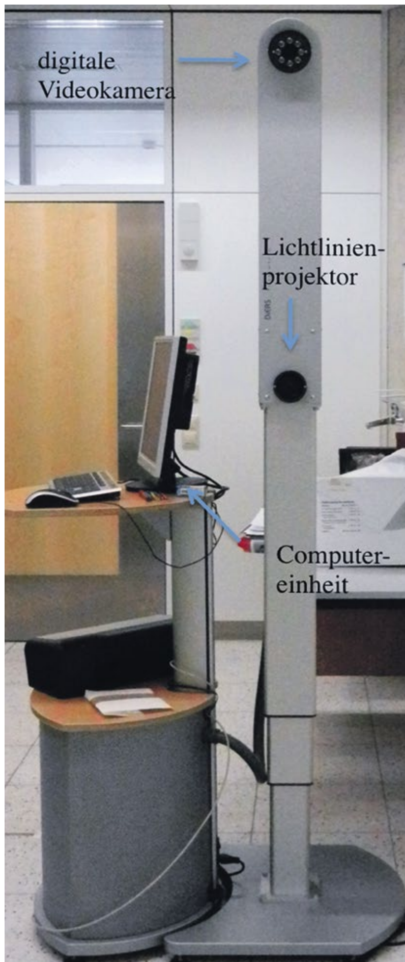
Abb. 1: Ein rasterstereografisches Messsystem besteht aus einem Lichtlinienprojektor, einer digitalen Videokamera und einer Computereinheit.
