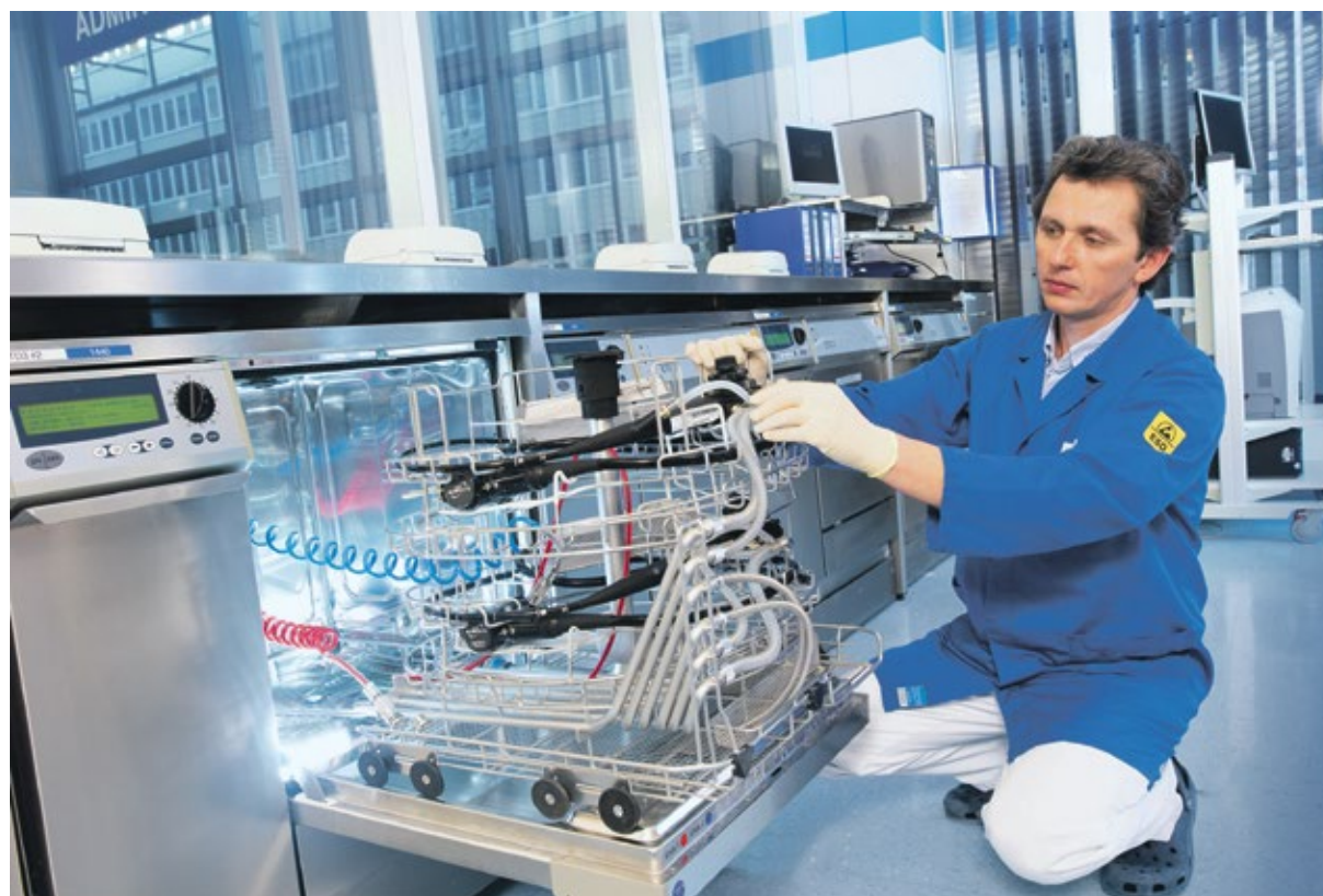
Aufbereitung der flexiblen Endoskope im Endo-Thermo-Desinfektor
