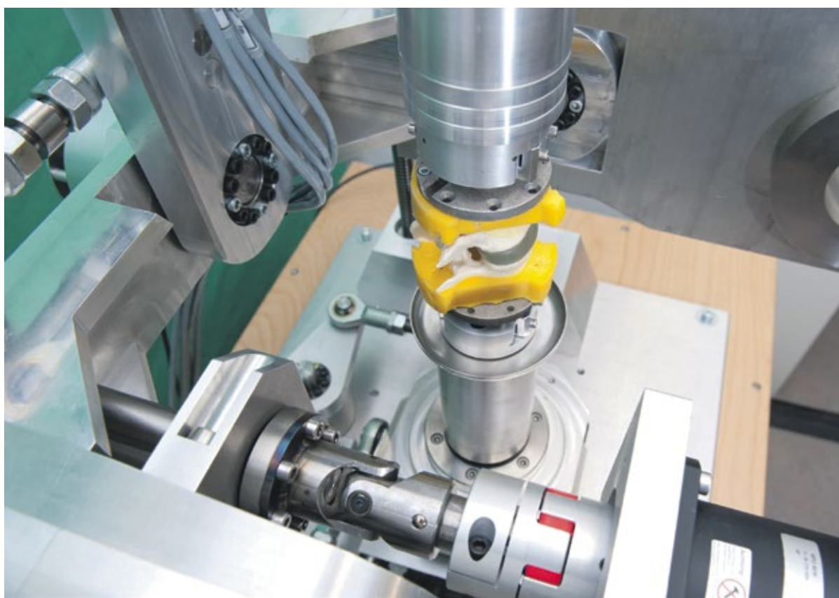
Der neue Bandscheibenbelastungssimulator aus der Wissenschaftlichen Werkstatt der Uni Ulm
