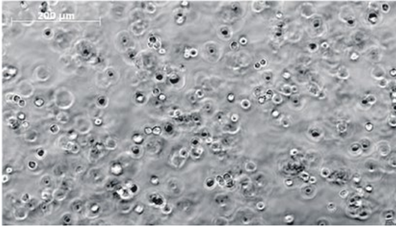
Abb. 2: Zellbeladenes, polymerisiertes Hydrogel im Mikroskop
