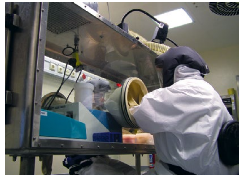
Arbeiten am Institut für Mikrobiologie der Bundeswehr Hochsicherheitslabor an einer Sicherheitswerkbank Klasse III.
