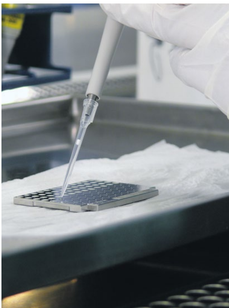
Vorbehandelte und inaktivierte Bakterienproben werden zur Untersuchung mittels MALDI-TOF Massenspektrometrie auf einen Edelstahlträger aufgetragen.
