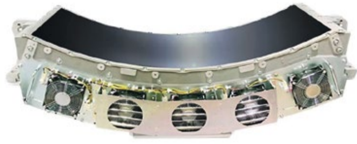
Neuer Toshiba-Pure-Vision-Detektor für die Volumen-CTs Aquilion ONE Next Generation und Aquilion ONE VISION Edition, deutlich erkennbar ist die breite Abdeckung in z-Richtung, 16 cm werden pro Rotation erfasst, ohne dass der Patient während des Scan verschoben werden muss. Insbesondere für Low-Dose-Cardio-CTs und für neuroradiologische Untersuchungen bietet die breite Abdeckung herausragende Vorteile.
