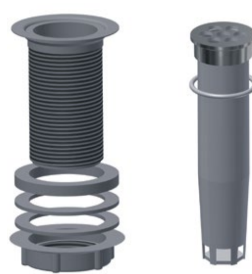
Aqua free-HygieneSiphon zur Vermeidung von retrograder Kontamination aus dem Siphon. Durch die spezielle Form des HygieneSiphons wird zusammen mit einem Inlet das Austreten von Spritzwasser und Aerosolen aus dem Siphon bei ablaufendem Wasser unterbunden. Damit wird das entsprechende Kontaminationsrisiko für die endständigen Sterilfilter an Waschbecken deutlich reduziert.
