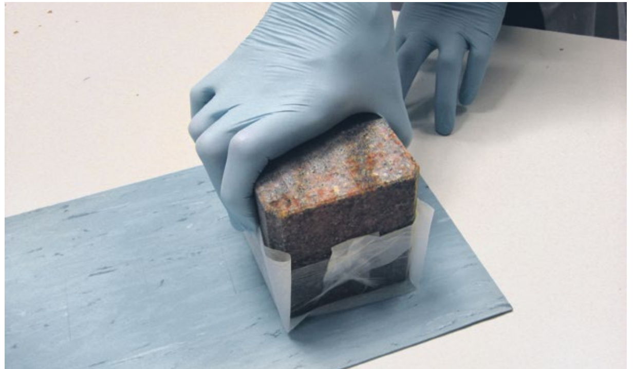
4-Felder-Test zur Prüfung der Viruzidie von Flächendesinfektionsmitteln mit Mechanik
