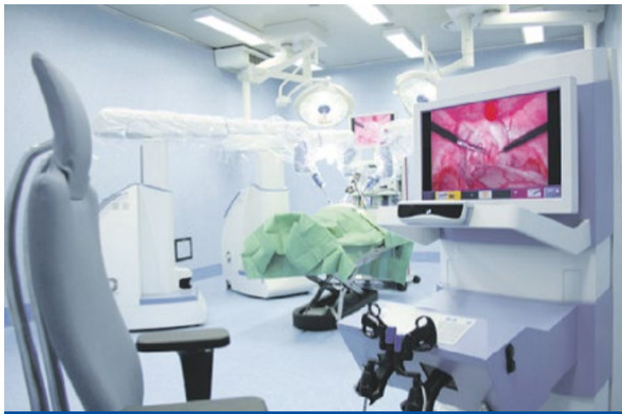
Senhance: Ursprünglich als Telelap-ALF entwickelter Operationsroboter mit offener Konsole, 3-D-Videobild mit Polarisationsbrille, Laparoskopie-artige Handgriffe. Drei separat auf Wagen angeordnete Roboterarme. Blickgesteuerte Kameraführung, Instrumente mit 5-7 Freiheitsgraden und Möglichkeit des taktilen Feedbacks.
