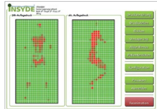
Die intelligente Matratze erkennt mit Sensoren den Auflagedruck des Patienten
