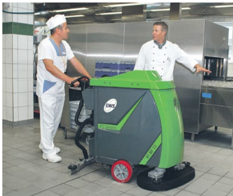
Dank ausgefeilter technischer Details erzielt das TÜV-geprüfte GWS eine Steigerung der Flächenleistung um mindestens 50% je Tankfüllung und ein Einsparpotential von mindestens 50% bei Wasser- und Chemieverbrauch.
