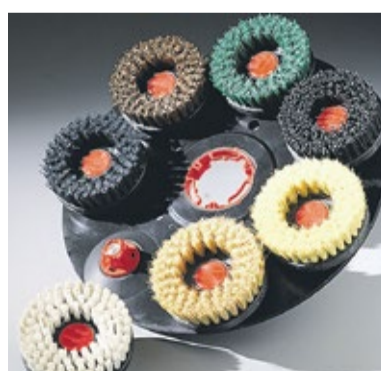
Bei dem patentierten Planetasystem dreht sich der Masterteller (schwarze Grundplatte) in Gegenrichtung kontrarotierend zu den leicht schräg aufgesetzten Subbürsten. Somit erfolgt die mechanische Reinigungswirkung bis tief in die Verdrängungsräume der GS-Fliesen hinein.
