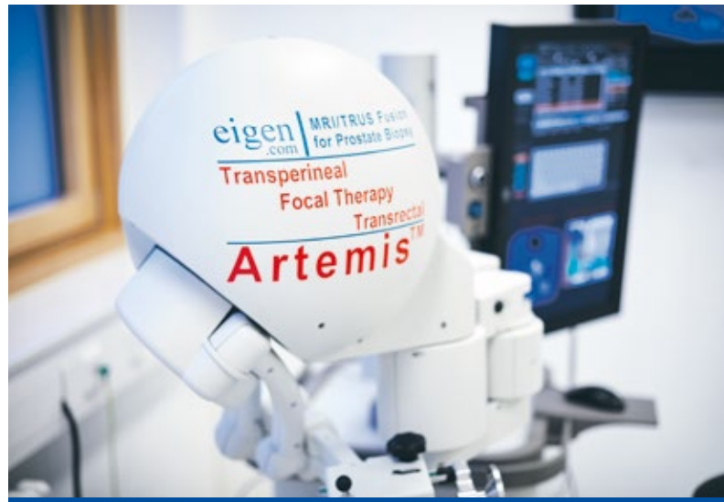
Das Artemis-System ermöglicht eine semirobotisch geführte Fusionsbiopsie in Kombination von multiparametrischem MRT und Ultraschall in Echtzeit.
