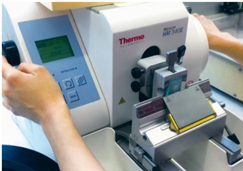
Abb. 1: Aufbereitung von 2 Mikrometer dünnen Gewebeschnitten vom Paraffinblock auf einem Mikrotom erfordert Kompetenz und manuelle Geschicklichkeit eines medizinisch-technischen Assistenten.
