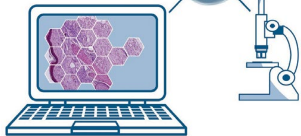
Abb. 1: Kostengünstige Alternative zu Slide-Scannern: mit Kamera ausgestattetes Mikroskop angeschlossen an Computer, auf dem vom Fraunhofer IIS entwickelte iStix Software läuft. Foto: Fraunhofer IIS
