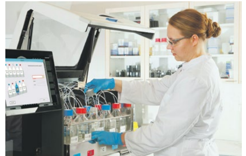
Eine Labormitarbeiterin beim Austausch von Laufmitteln am Thermo Scientific Cascadion SM Clinical Analyzer. Foto: Thermo Fisher Scientific
