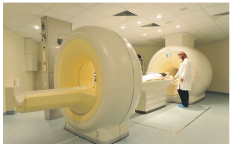
Fast zeitgleich kann das PET/MRT-Kombinationsgerät den Stoffwechsel von Tumoren mit Positronen-Emissions-Tomografie (PET) und deren Lage mit Magnet-Resonanztomografie (MRT) bildlich darstellen.
