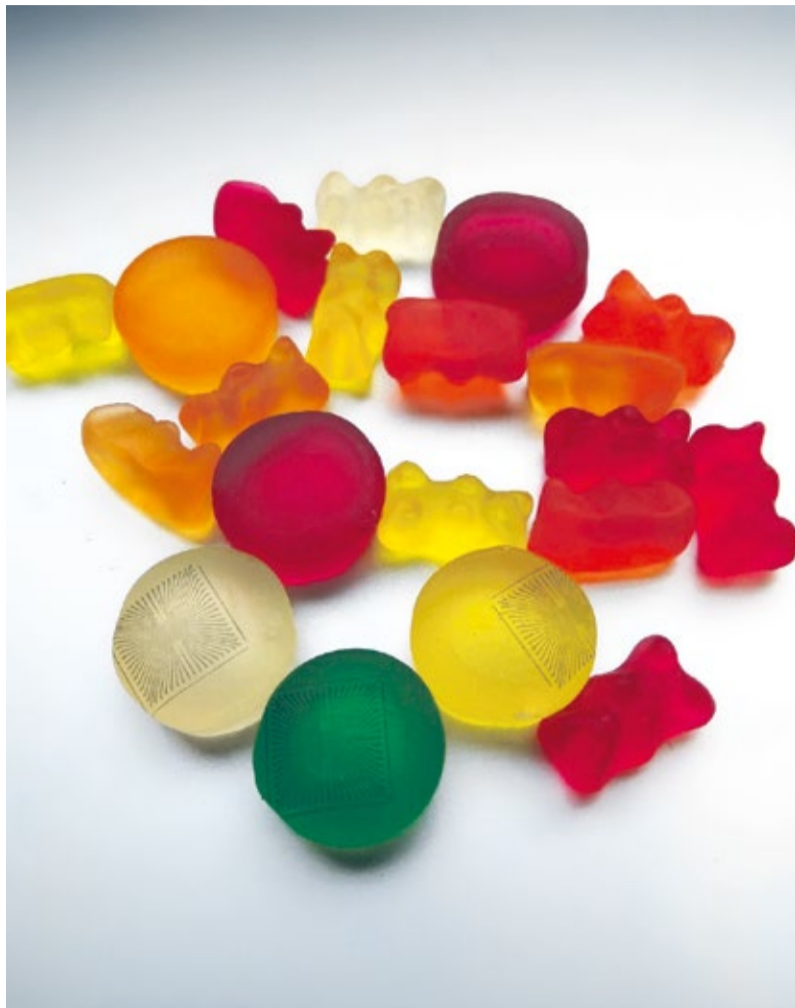
Mikroelektroden-Arrays auf Gelatine: Ein Team um Bernhard Wolfrum, Professor für Neuroelektronik an der Technischen Universität München (TUM), hat die Sensoren auf Gummi-Süßigkeiten gedruckt. Foto: N. Adly / TUM
