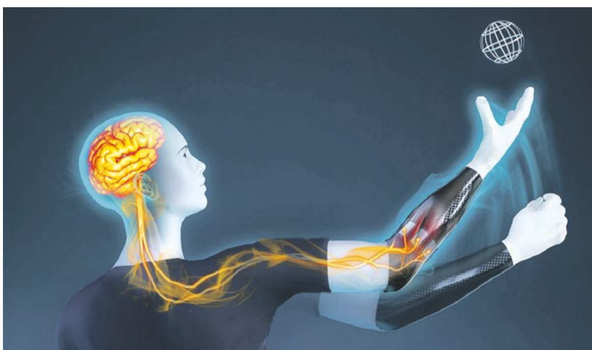
Die neuartige simultane Prothesensteuerung interpretiert die neuronalen Signale des Anwenders indirekt durch Auswertung schwacher elektrischer Potentiale der Stumpfmuskulatur. Foto: mg/imperial
