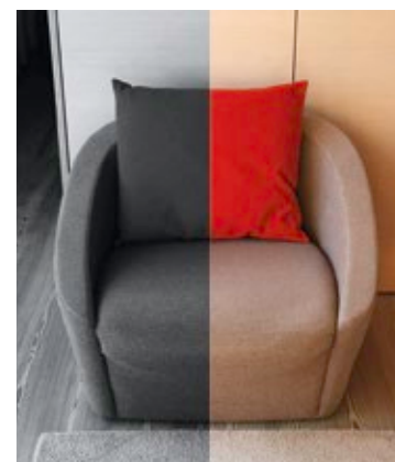
Zu geringer Leuchtdichtekontrast zwischen Kissen, Sessel und Bodenbelag. Bild: BifadA
