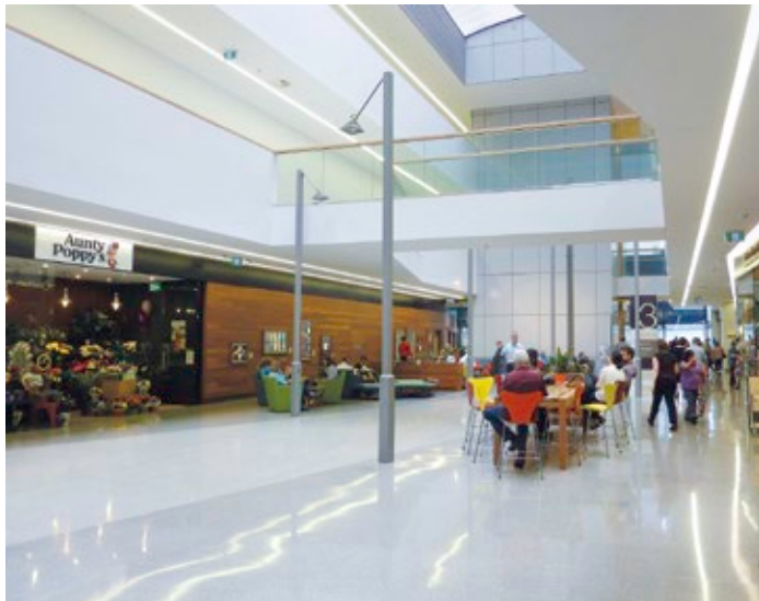
Spiegelnde und reflektierende Oberflächen werden als Wasser und Fußmatten im Eingang als Loch wahrgenommen und erhöhen die Unsicherheit und damit das Sturzrisiko. Bild: BifadA
