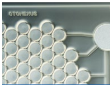
Der einzigartige CMUT-Chip des Fraunhofer IPMS nutzt Ultraschall für das Otoskop der US-amerikanischen Firma OtoNexus Medical Technologies. Foto: Fraunhofer IPMS
