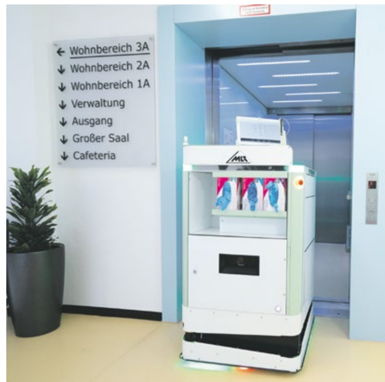
Der intelligente Pflegewagen kann autonom navigieren und vereinfacht die Dokumentation verbrauchten Materials. Foto: Fraunhofer IPA
