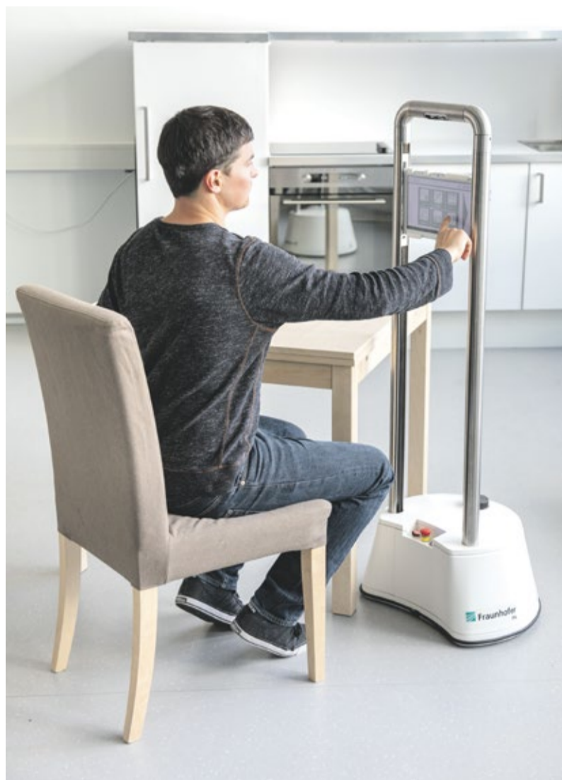
MobiKa: Der mobile Kommunikationsassistent MobiKa hat ein höhenverstellbares Tablet und unterstützt z. B. Telepräsenz-, Interaktions- oder Erinnerungsfunktionen. Foto: Fraunhofer IPA
