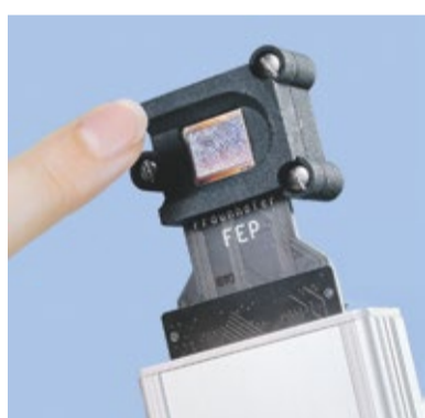
Fingerprintsensoren basierend auf der bidirektionalen Displaytechnologie Foto: Fraunhofer FEP
