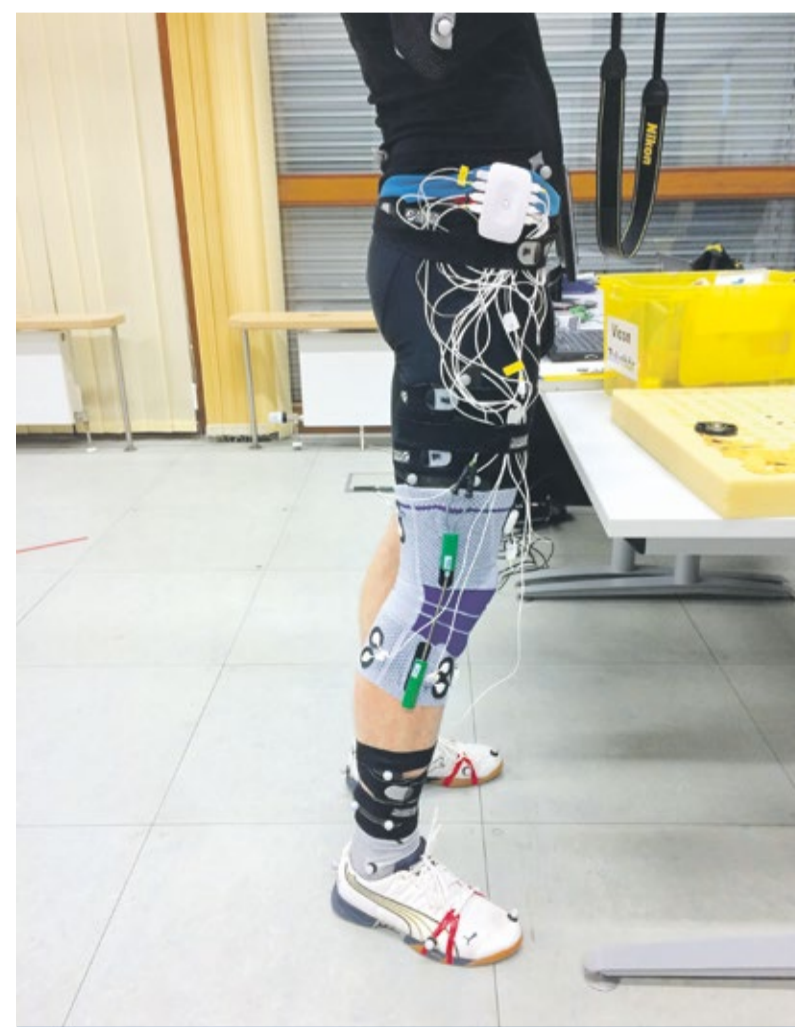
Mobile Sensoren messen die Bewegung des Kniegelenks. Die Messwerte bilden die Trainingsdaten für Algorithmen des maschinellen Lernens, um die Belastung des Kniegelenks schätzen zu können. Foto: IStS
