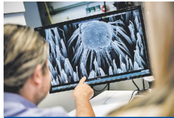
Mittels Rasterelektronenmikroskopie kann die Interaktion zwischen biologischen Objekten wie Zellen und Bakterien mit den nanostrukturierten Oberflächen untersucht werden. Foto: Damian Gorczany
