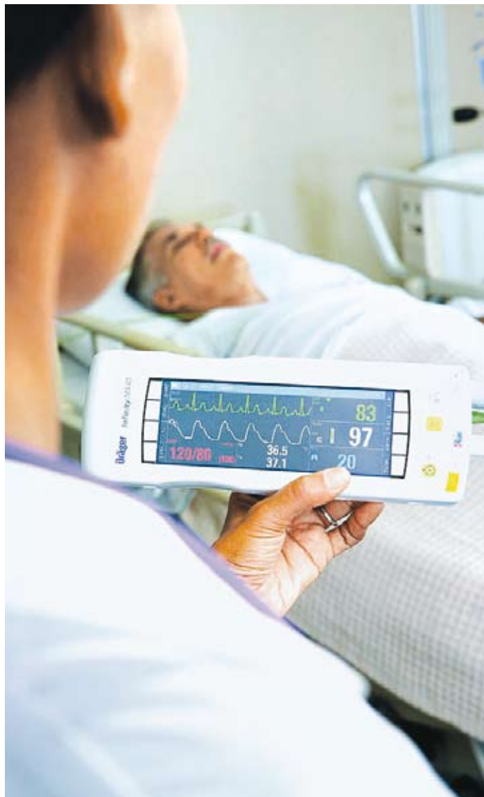
Der Infinity M 540 verbleibt über den ganzen Klinik-Aufenthalt beim Patienten, sowohl am Bett als auch beim innerklinischen Transport, zeichnet Vitaldaten auf und speichert diese.
