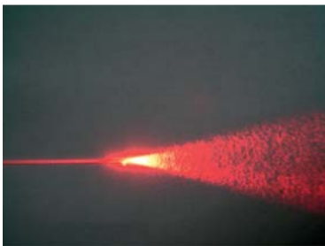
Abb. 2a: Bare fiber: gerade Spitze.
