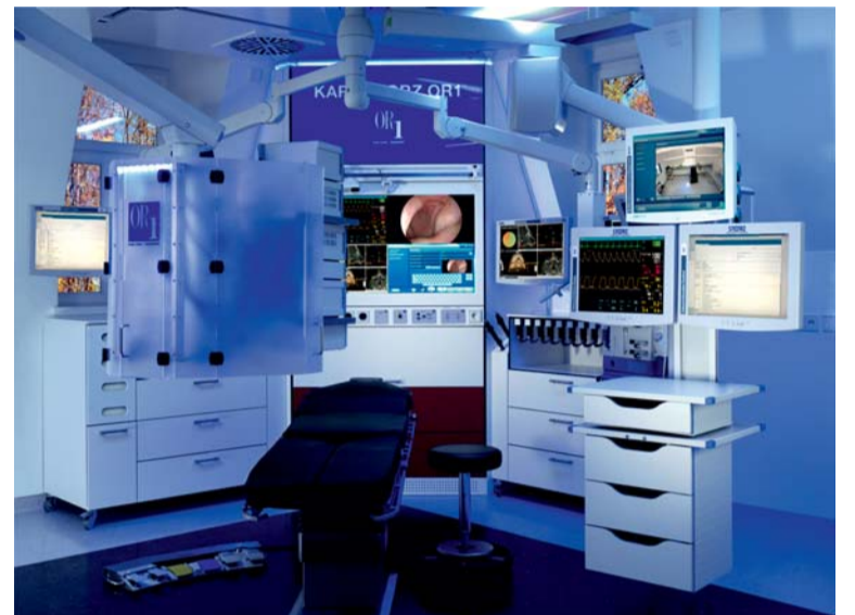
Abb. 1: Prototyp des integrierten Operationssaals mit den Arbeitsbereichen Surgical Cockpit, Airway Cockpit, Technisches Cockpit und Technisches Compartment. © IRDC Leipzig
