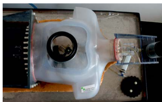
Abb. 1: Thoraxphantom, bestehend aus Plastiktorso und Einsätzen für Lungen, Herz und Leber.
