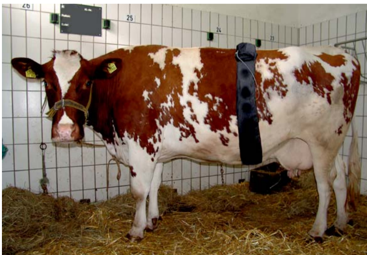
Abb. 3: Ruminograph mit vier Drucksensoren, mittels Bauchgurt am Probanden befestigt.
