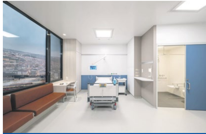
Statt auf antibakterielle Oberflächen setzt KARMIN auf leicht zu reinigende Materialien. Für den Demonstrator kam daher auch der Kautschukboden Noraplan Sentica zum Einsatz.
