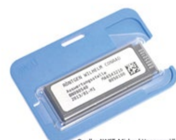
Quelle: AWST, Michael Hagenmüller Abb. 2: Modernes OSL-Dosimeter. Dieses kann nicht nur mehrmals ausgelesen werden und hilft somit, Müll zu vermeiden, es besitzt auch eine hohe Empfindlichkeit (niedrige messbare Mindestdosis) und ist somit für die Überwachung in strahlungsarmen Umgebungen besonders geeignet.
