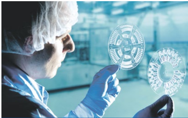
Abb. 1: Hahn-Schickard entwickelt Schnelltests zur Vor-Ort-Analyse z. B. von Krankheitserregern. Hier zwei Varianten im CD-Format, welche als Einwegkartuschen hergestellt werden und komplexe Analyseprozesse abbilden. Foto: Bernd Müller Fotografie, Hahn-Schickard
