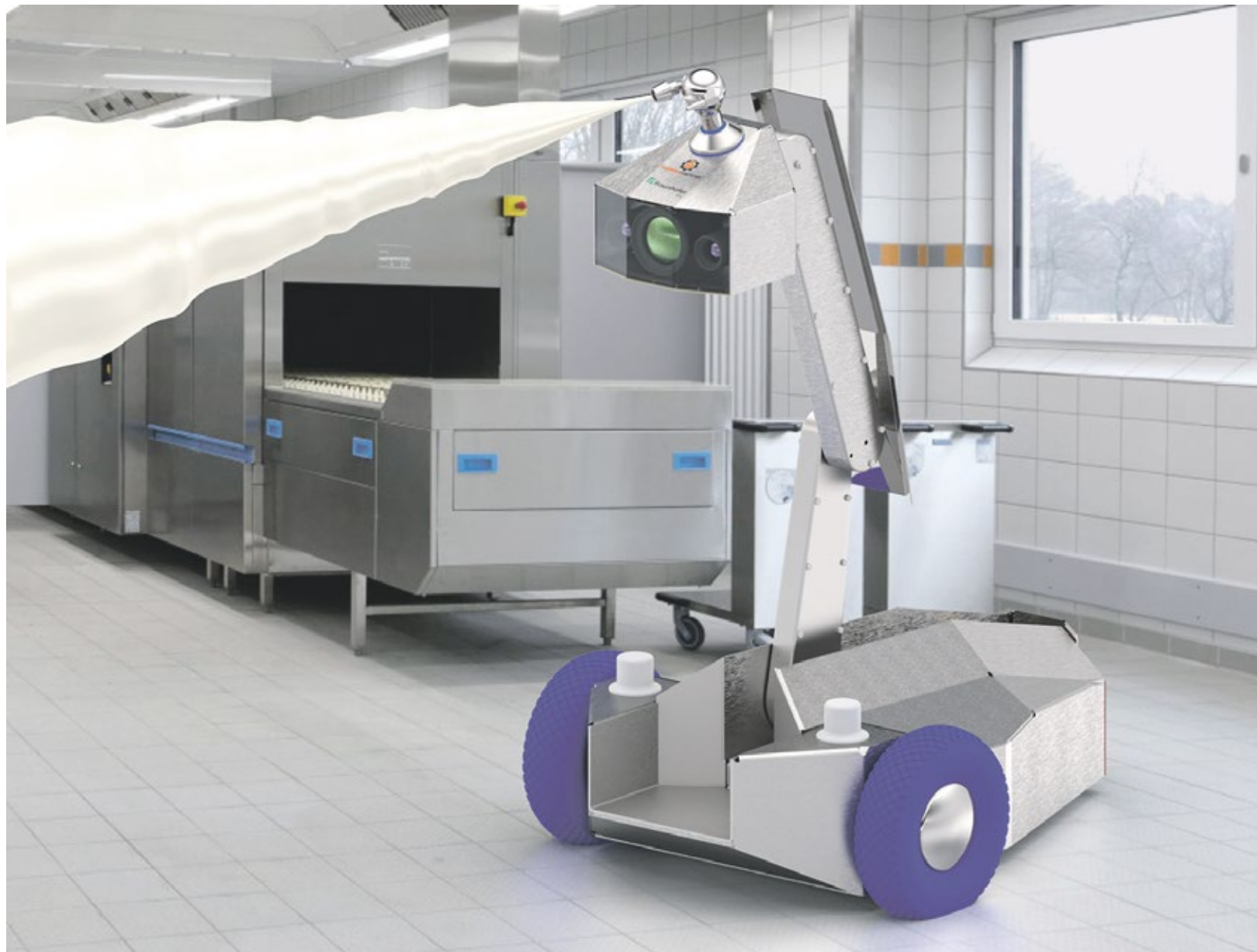
Der ausfahrbare Roboterarm des Mobile Cleaning Device 4.0 mit Zielstrahlreiniger erreicht auch höher gelegene Anlagenbereiche.
