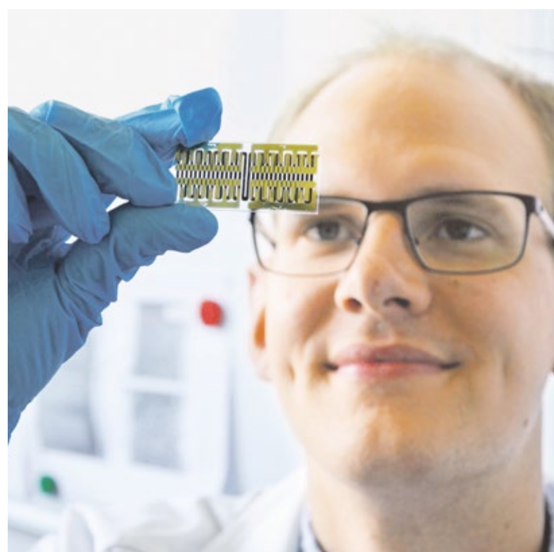
Auf dem Glasräger befinden sich hochempfindliche Gas-Sensoren aus dem 3-D-Drucker. Foto: Julia Siekmann, Uni Kiel
