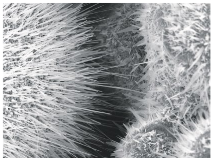
Die Sensoroberfläche unter dem Mikroskop: Aus metallischen Mikropartikeln lässt das Forschungsteam winzige Spitzen wachsen, an denen sich Gasmoleküle besonders gut verfangen. Foto: AG Funktionale Nanomaterialien, Julia Siekmann, Uni Kiel
