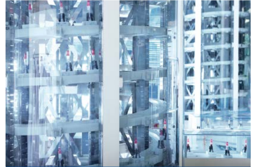
Abb. 1: Spiralen ermöglichen einen barrierefreien Probentransport auch etagenübergreifend. Foto: MVZ Labor 28
