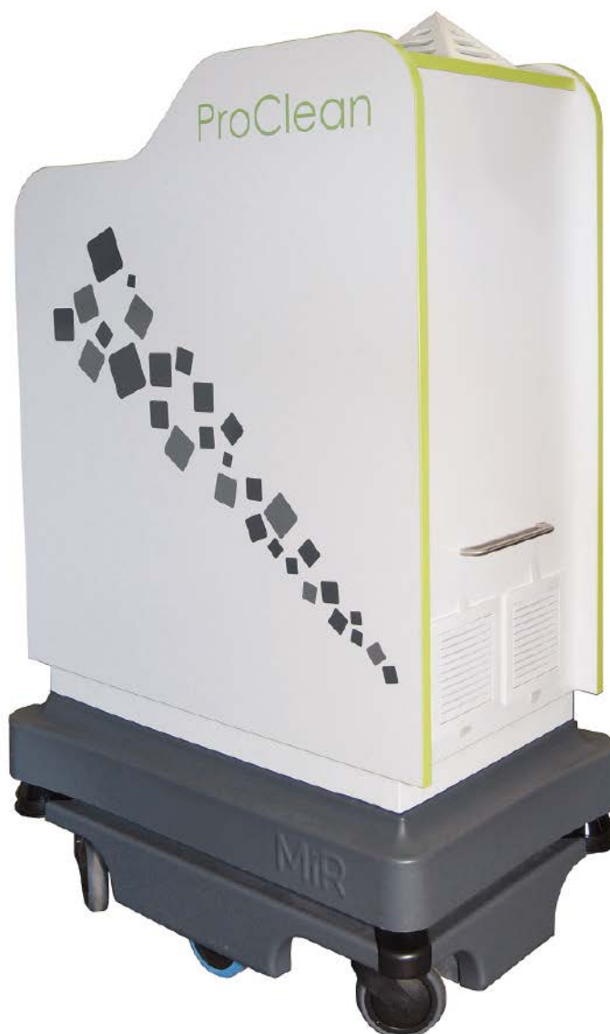
Pro Clean von Medimobil, ein autonom fahrendes Reinigungsgerät, das Luft in geschlossenen Räumen zu 99,99% desinfiziert.
