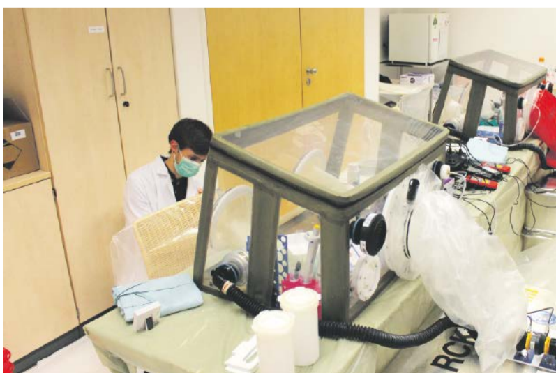
Die sichere Handhabung der Patientenproben (bis zur Risikogruppe 4, im Falle SARS-CoV-2 RG 3) erfolgt in Biosicherheitshandschuhkästen mit Gebläsefilter und Unterdruck. Nach dem Ausschleusen der inaktivierten Proben können diese gefahrlos der RT-PCR zugeführt werden. Foto: KNO AG
