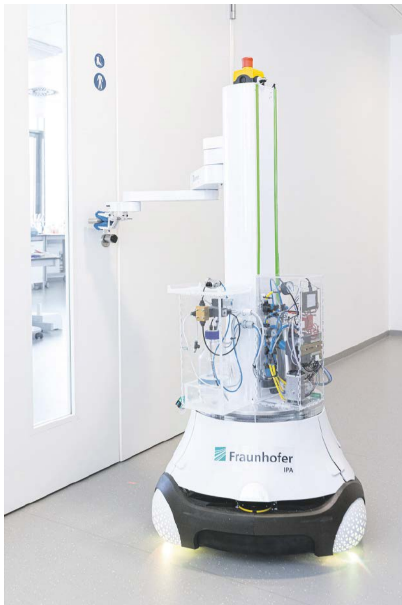
Der mobile Reinigungs- und Desinfektionsroboter DeKonBot fährt selbstständig zu kritischen Objekten wie Türgriffen und desinfiziert diese. Foto: Fraunhofer IPA, Rainer Bez
