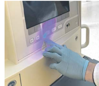
Überprüfung eines Medizinprodukts bezüglich der Reinigbarkeit mittels eines Fluoreszenztests
