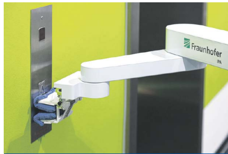
Mithilfe seines flexiblen Reinigungswerkzeug kann DeKonBot eine Wischdesinfektion unterschiedlicher Objekte, bspw. auch Aufzugknöpfe, durchführen. Foto: Fraunhofer IPA, Rainer Bez
