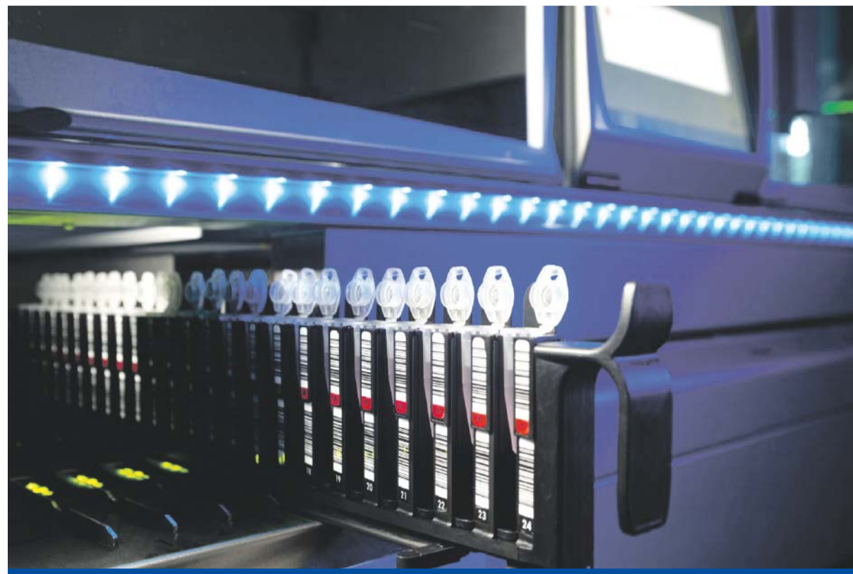
Mit der automatisierten DNA-Isolation lassen sich bis zu 44 klinische Proben gleichzeitig aufbereiten. Foto: Fraunhofer
