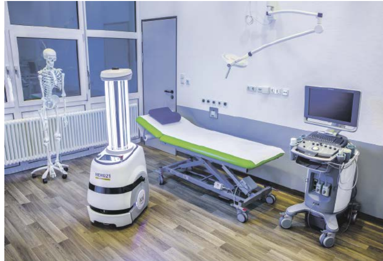
Der HERO21 während der Desinfektion eines Behandlungsraumes im St. Josef-Hospital
