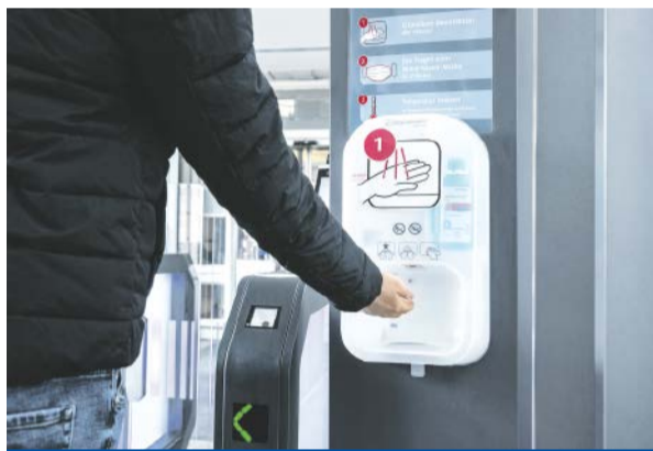
Erst nach erfolgter Händedesinfektion öffnet sich die Zutrittschleuse.
