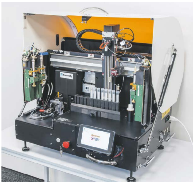
CTCElect-Demonstrator für die vollautomatisierte Isolierung von zirkulierenden Tumorzellen aus einer 7,5-ml-Blutprobe
