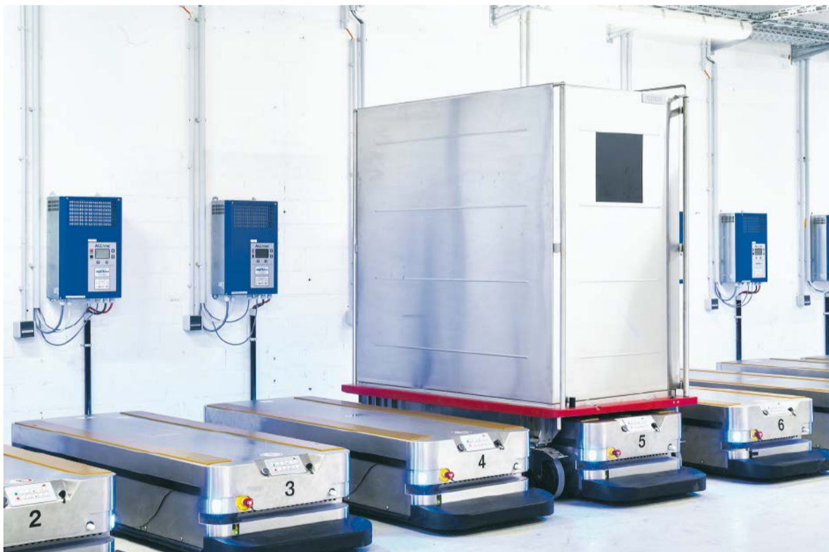
Ein bestückter Container gelangt mithilfe des Transport-Roboters zur jeweiligen Station.
