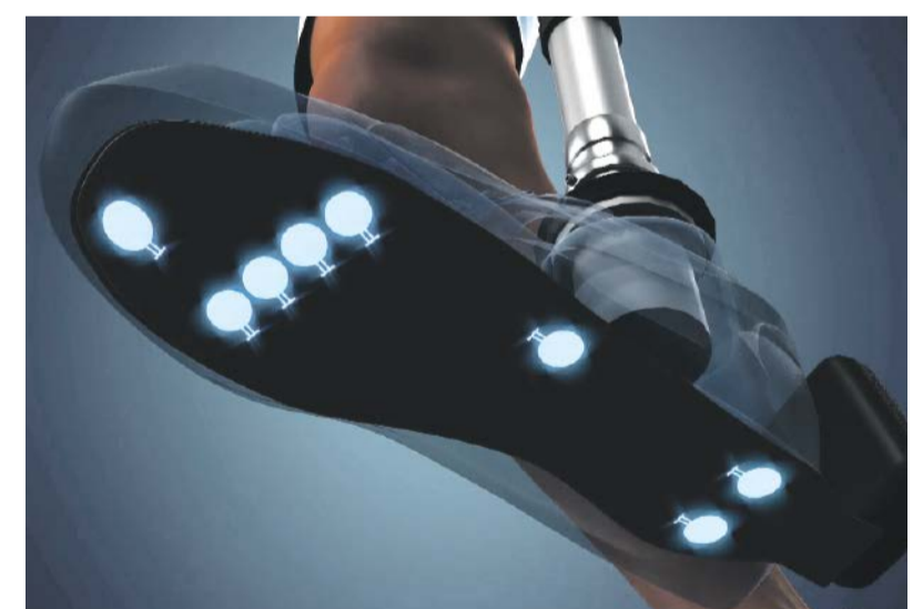
Prothese mit Tastsensoren an der Sohle
