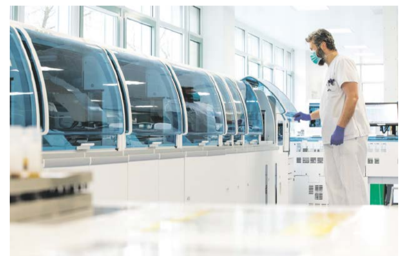
Laborproben werden auf Pucks zu den Analysegeräten gebracht und vollautomatisch auf die gewünschten Parameter hin untersucht.
