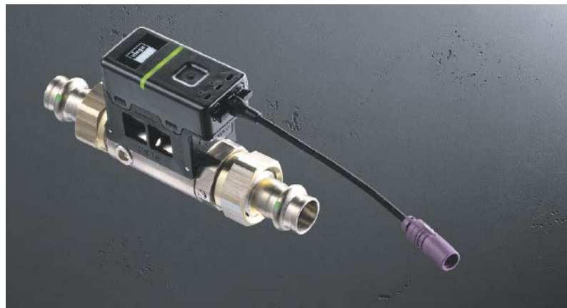
Mit dem „AquaVip-Zirkulationsreguliertventil elektronisch“ lassen sich Trinkwasser-Zirkulationsleitungen im Bestand auch ohne genaue Kenntnis der Anlagendaten zuverlässig auf 60/55 °C thermisch abgleichen.
