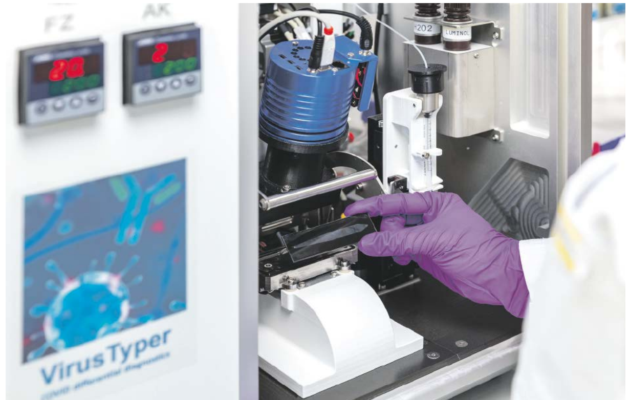
Auf Basis der Microarray-Analyseplattform MCR der Münchner GWK Präzisionstechnik GmbH hat ein Forschungsteam der Technischen Universität München (TUM) einen neuen Mikroarray-basierten Schnelltest auf Antikörper gegen SARS-CoV-2 entwickelt.
