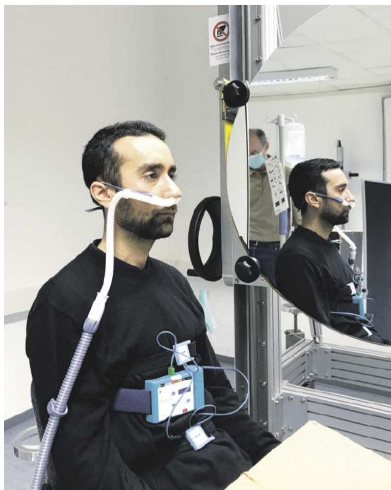
Eine gesunde männliche Testperson sitzt vor dem Schlierenspiegel und trägt das NHF-Therapiegerät. Foto: Amayu Wakoya Gena, Bauhaus-Universität Weimar
